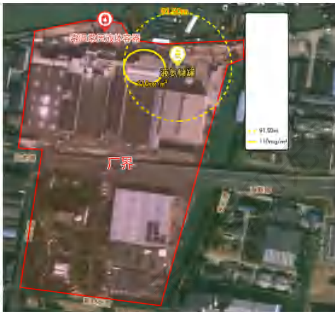
图 6.8-2 液氨储罐泄漏事故控制距离图-最不利气象条件
